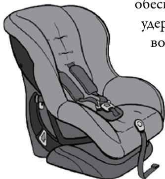
должно ограничивать движение головы вперед при лобовом ударе и обеспечивать защиту от ранений при боковом ударе. Поэтому детская удерживающая система должна перераспределить силу удара на возможно большую площадь. Ремни и лямки должны быть хорошо подогнаны и правильно надеты в соответствии с инструкциями производителя. Удерживающая система также должна обеспечить защиту от соприкосновения с деталями салона, как при фронтальном, так и при боковом ударах.
